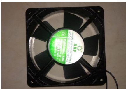
ภาพที่ ๒.๓ พัดลมระบายความร้อน
