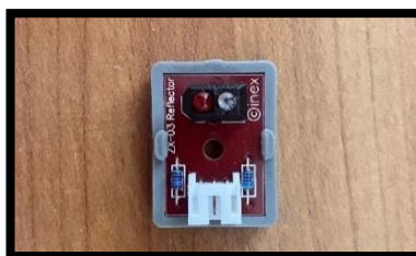
รูปที่ 10 ภาพแสดงชุดเซนเซอร์ตรวจจับวัตถุ
