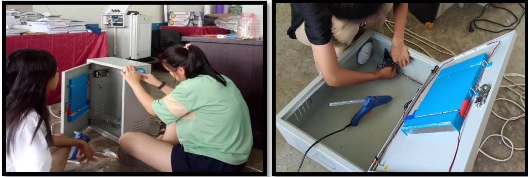
ภาพที่ 13 แสดงขั้นตอนติดตั้งอุปกรณ์ ระบบการทำงานของตู้แลกดินสอดด้วยขวดพลาสติก กับบอร์ด kidbright
