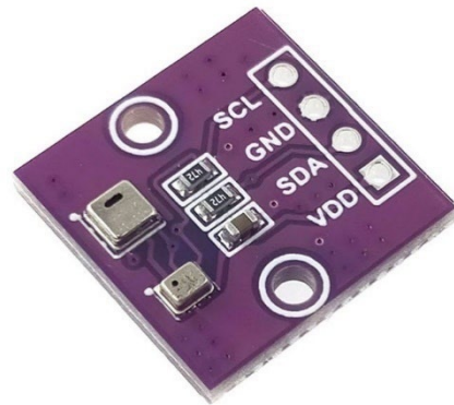
ภาพที่ 4 เซ็นเซอร์วัดอุณหภูมิและความชื้น AHT20 + เซ็นเซอร์วัดความดันอากาศ BMP280
