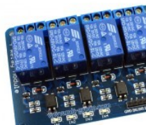
รูปที่ 5.1 บอร์ดโมดูลรีเลย์ 4ช่อง 5V Optocoupler (4 Channel Relay Module)
