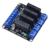
รูปที่ 5.2 บอร์ดรีเลย์ DC 4ช่อง ระดับสูงโซลิตสเตรรีเลย์โมดูล250โวลต์2A
