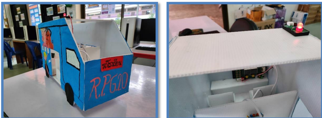
ภาพที่ ๔.๖ เครื่องมือของระบบแจ้งเตือนเด็กติดภายในรถยนต์ บอร์ด KidBright ตัวที่ ๒ มีการกด Switch ๑ บนบอร์ด KidBright จะแสดงไฟและเสียงแจ้งเตือนตามที่เขียนโปรแกรมไว้
