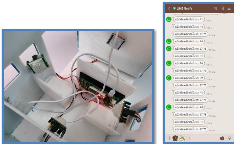
ภาพที่ ๔.๕ เครื่องมือของระบบแจ้งเตือนเด็กติดภายในรถยนต์ เมื่อบอร์ด KidBright ตัวที่ ๑ ตรวจจับการเคลื่อนไหวตามจุดต่าง ๆ ภายในห้องโดยสารของรถยนต์ได้
