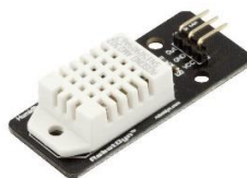
ภาพที่ 5 เซนเซอร์วัดอุณหภูมิความชื้นดิจิทัล DHT22
