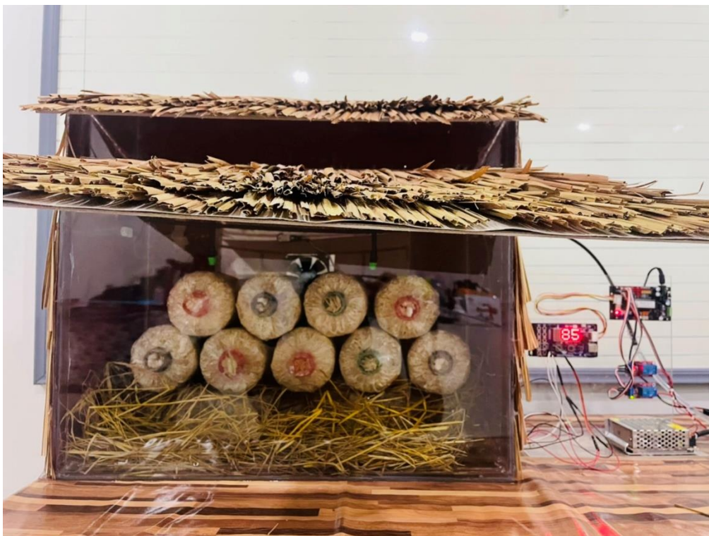
ภาพที่ 20 แบบจำลองระบบพ่นหมอกในโรงเรือนเห็ดนางฟ้าอัตโนมัติ
