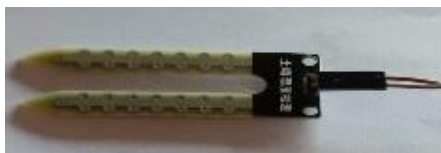
รูปที่ 2.1.4 เซ็นเซอร์วัดความชื้นในดิน แหล่งที่มา : รูปถ่ายจริงของผู้ทำโครงการ
