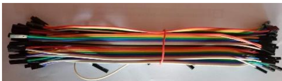
รูปที่ 2.1.2 สายจัม แหล่งที่มา : รูปถ่ายจริงของผู้ทำโครงการ
