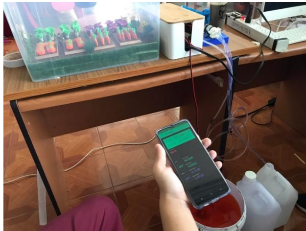
ภาพที่ 3.2 การทดสอบการสั่งงานผ่านแอปพลิเคชัน Blynk
