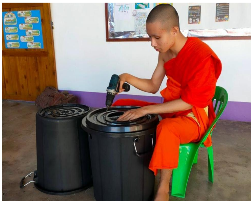
ภาพที่ 9 เจาะถังน้ำ เพื่อให้ช่วยระบายน้ำ
