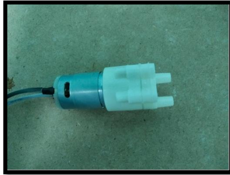
ภาพที่ 2.19 มอเตอร์พ่นหมอก ระบบพ่นหมอกแรงดันสูง
