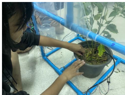
รูปที่ 6 รูปแสดงขั้นตอนติดตั้งอุปกรณ์ สายไฟ และเซ็นเซอร์วัดค่าความชื้นในดินบนแผงบอร์ด KidBright
