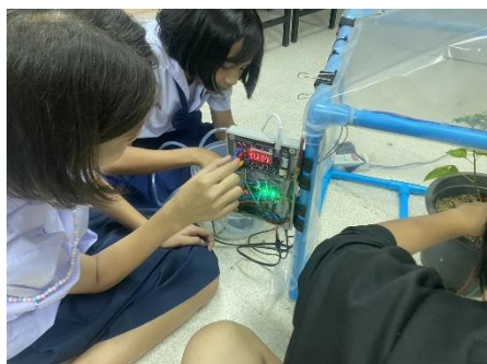
รูปที่ 6 รูปแสดงขั้นตอนติดตั้งอุปกรณ์ สายไฟ และเซ็นเซอร์วัดค่าความชื้นในดินบนแผงบอร์ด KidBright
