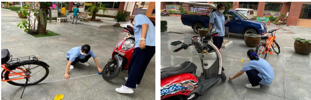
ภาพแสดง การวัดระยะเพื่อทดสอบการทำงานของเซ็นเซอร์พร้อมเก็บข้อมูล
