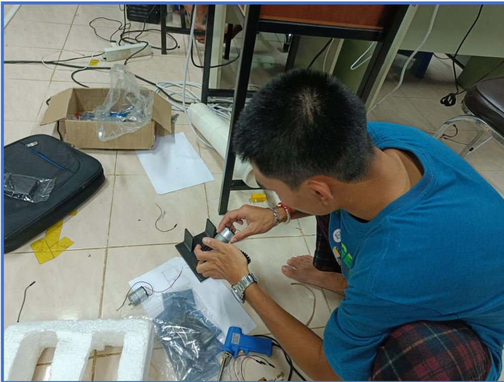
ประกอบชุดล้อตะขาบและประกอบกับโฟมเพื่อเป็นฐานของหุ่นยนต์
