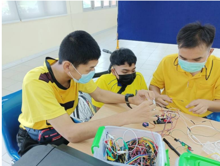
ภาพที่ 19 แสดงการต่อวงจรอิเล็กทรอนิกส์และเซนเซอร์ Ultrasonic และ Servo
